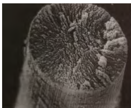
Рис. 1. Рабочая поверхность автокатаода из ПАН углеродного волокна
