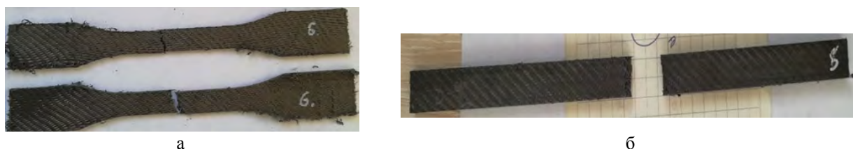
Рис.2 Разрушенные образцы после испытания на растяжение (а) и на 3-ех точечный изгиб (б)
