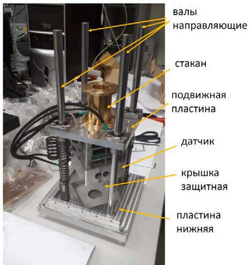
Рисунок 4 – Этап сборки конструкции с подписями установленных элементов
