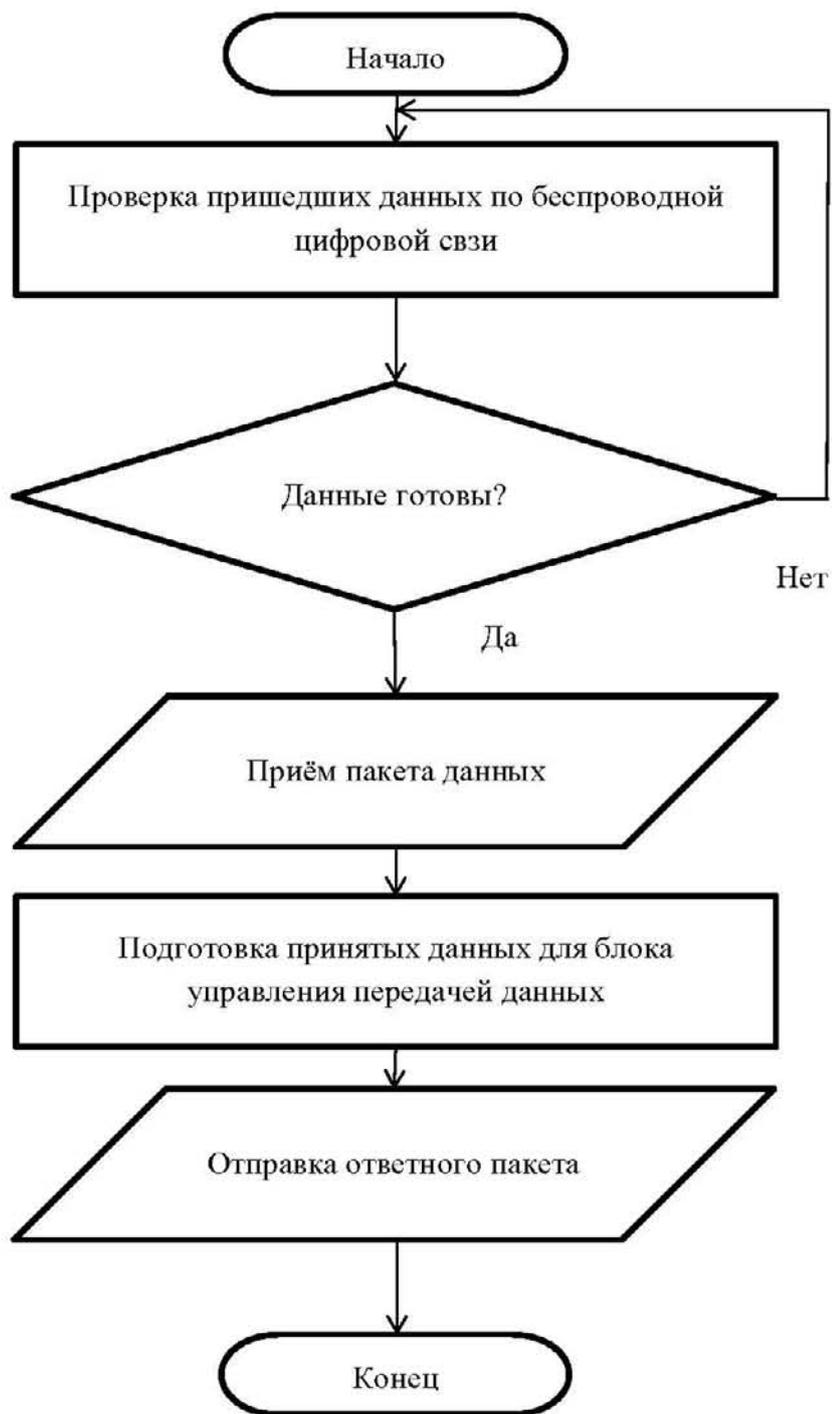
Рисунок ГА.3 – Блок-схема алгоритма работы блока управления беспроводной цифровой связью
