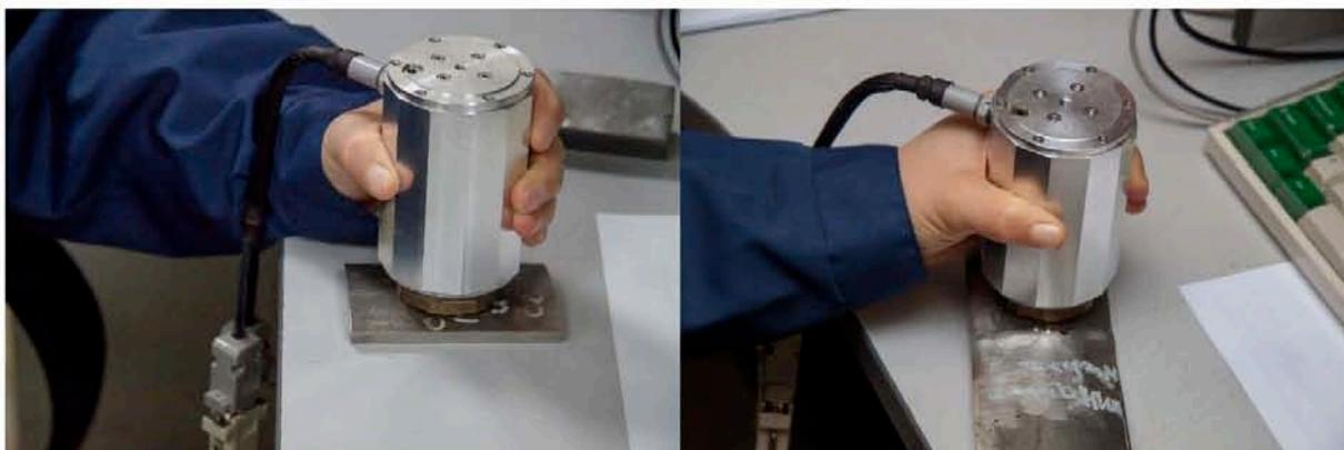
Рисунок 61 – Измерение образцов: а) ПЛЗ-273x16 35ХМА, б) ПЛЗ-426x8.0 38ХНВА
