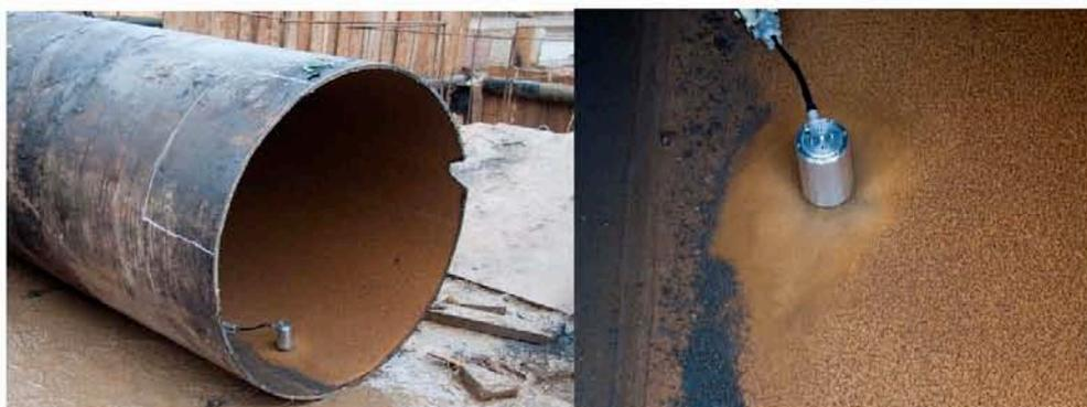
Рисунок 75 – Внешний вид подготовленной к измерениям поверхности трубы с установленным модулем оперативного контроля
