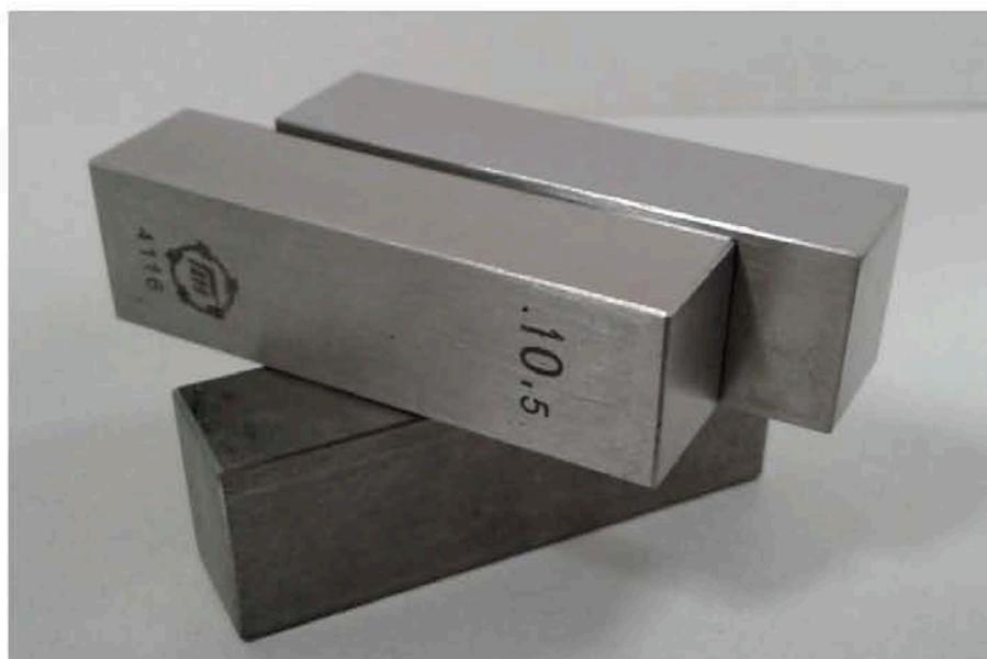
Рисунок 40 — Концевые меры образующие ступеньку 0,5 мм
