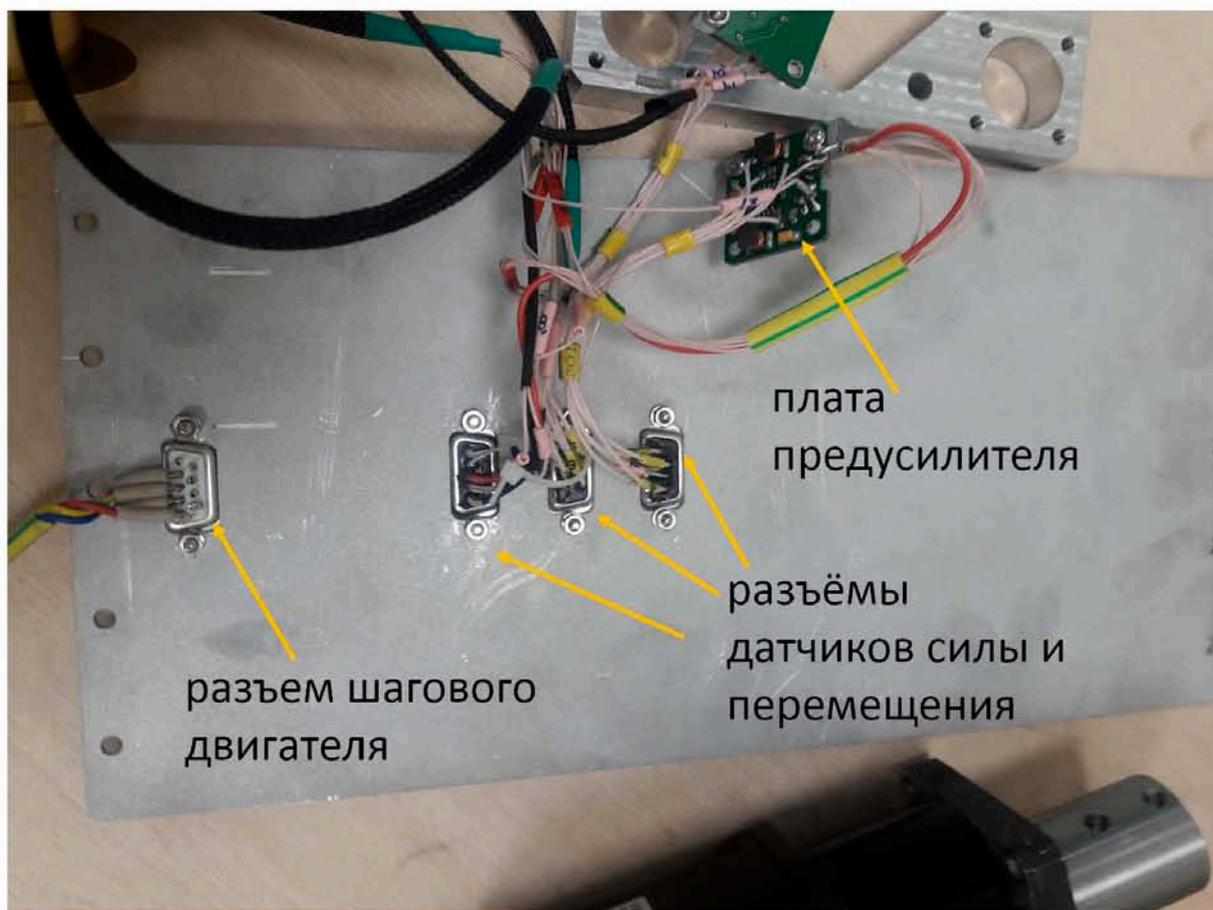
Рисунок 9 – Боковая стенка с установленными разъёмами для подключения датчика и шагового двигателя
