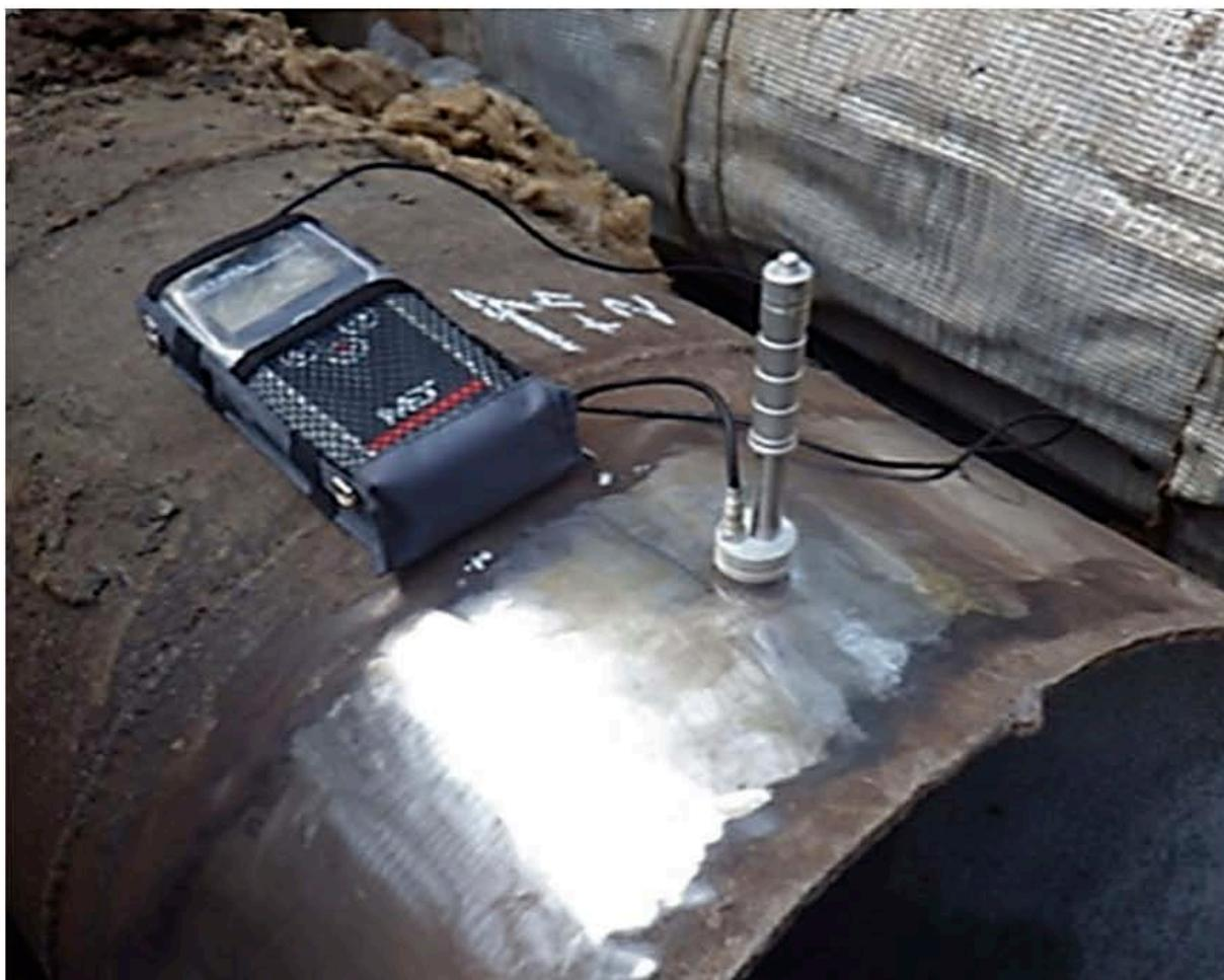
Рисунок 97 – Пример измерение твердости стенки трубопровода портативным прибором
