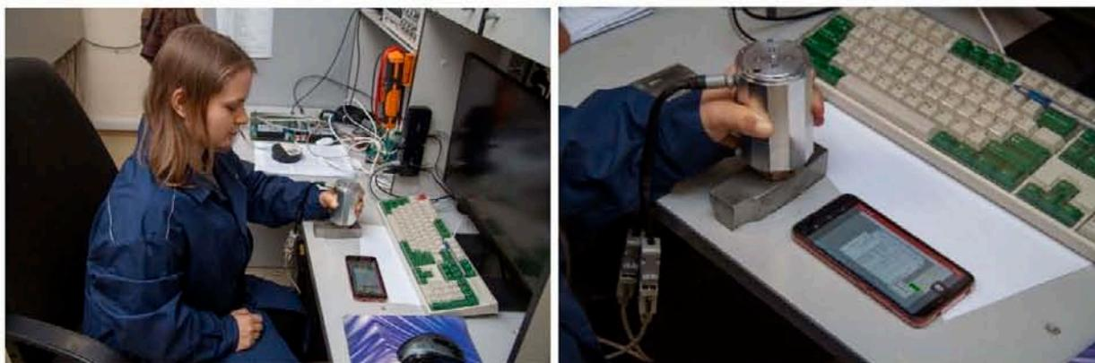
Рисунок 63 – Испытание образца ПЛЗ-325х9.0 40ХН2МА. Результаты измерений отображаются на экране смартфона
