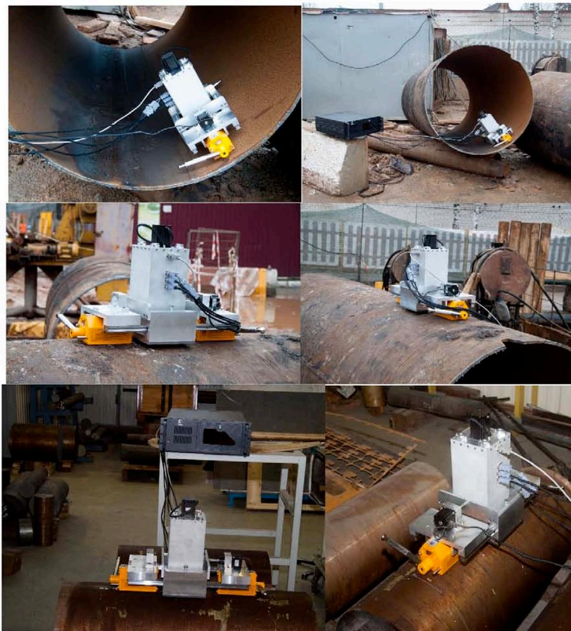
Рисунок 76 – Внешний вид iPoRTH, установленного с использованием магнитных захватов на внутренней и внешней поверхности термически обработанных труб
