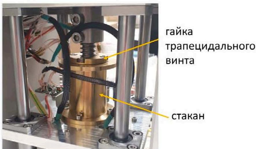
Рисунок 6 – Соединение элементов через гайку трапецеидального винта
