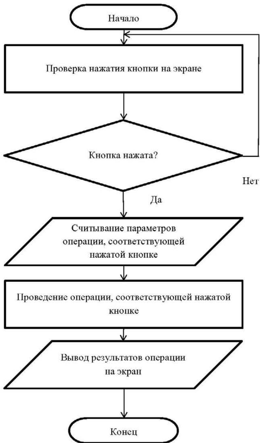
Рисунок ГА.1 – Блок-схема алгоритма работы блока управления модулем беспроводной цифровой связи
