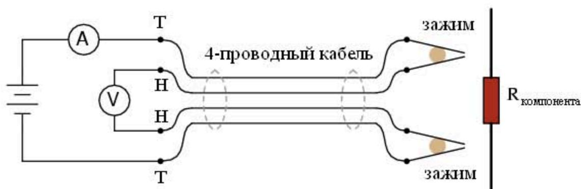
Рисунок 23 – Измерение сопротивления с использованием зажимов Кельвина
