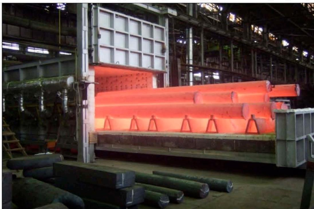
Рисунок 73 – Внешний вид печи ТермоГаз- ДО
