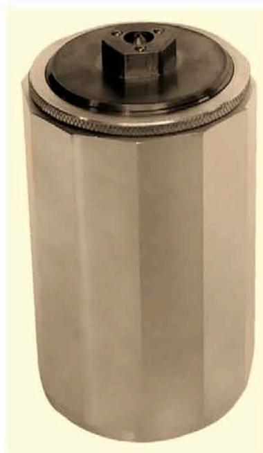
Рисунок 62 – Внешний вид модуля измерительного оперативного контроля (вид снизу): зафиксирована нижняя часть, предназначенная для измерения массивных образцов
